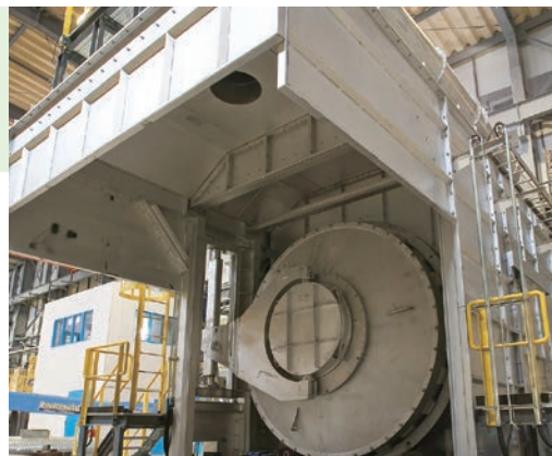
ダイセキMCR宇都宮リサイクルセンターの回転ガス熔解炉
