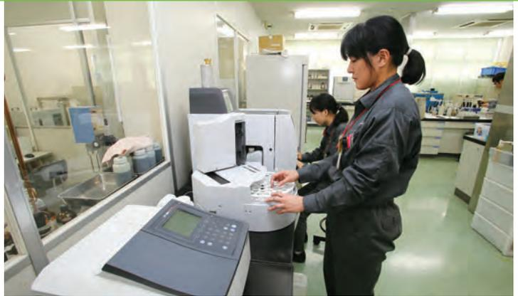
活性汚泥設備の品質管理を強化するため、2014年には全有機炭素を測定できるTOC計を新たに導入しました。これによって水質の測定時間が短縮できます。
