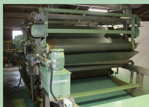
金属回収装置
